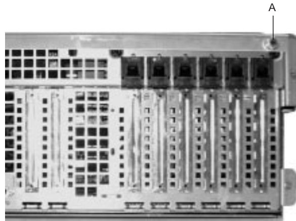
Abbildung 15. Eine von zwei Flügelschrauben zur Befestigung der oberen Abdeckung
