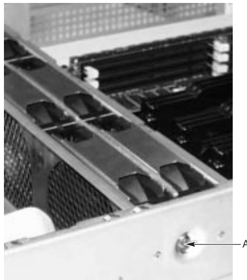
Abbildung 30. Eine der zwei Schrauben zur Befestigung der Kühlungseinheit
