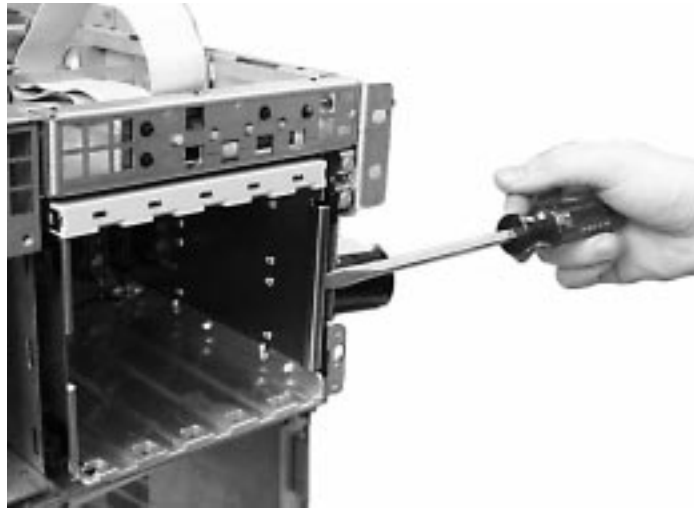
Abbildung 33. Ausbau des Festplattenschachts aus dem Gehäuse
