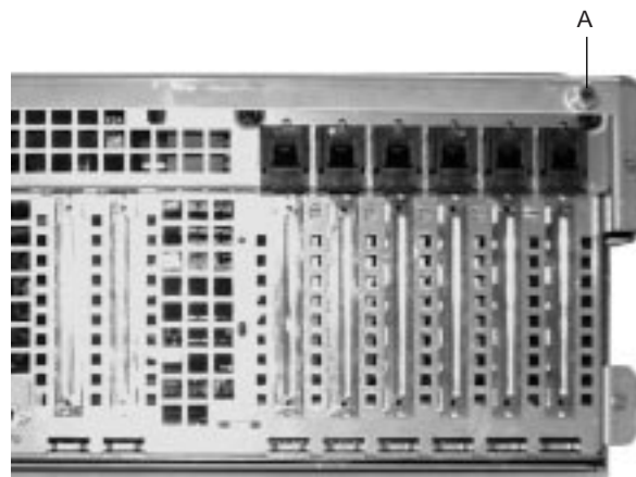
Abbildung 13. Eine von zwei Flügelschrauben zur Befestigung der oberen Abdeckung
