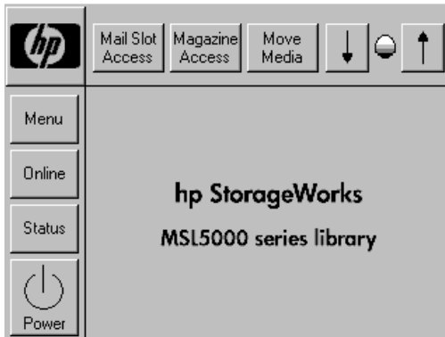
Figura 3–1: Pantalla Status (Estado) de la biblioteca (la figura muestra la biblioteca MSL5052)
