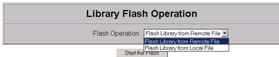
図3-7: リモート管理インタフェースを使用してファームウェアを更新する
