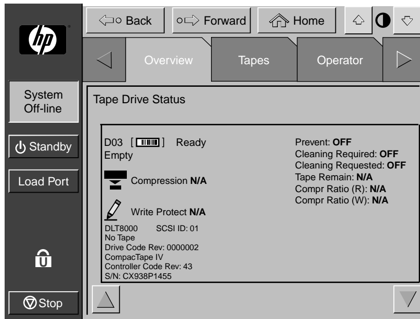
図3-4: [Tape Drive Status]ボックス（図はDLT8000の画面を示しています）
