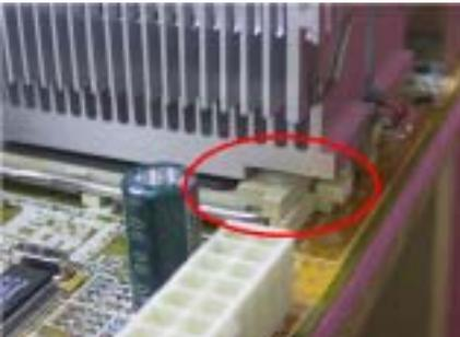
La photo de gauche vous montre la base droite du dissipateur entrant en contact avec le côté droit du socket. Dans cette situation, la surface du CPU n'est pas entièrement en contact avec le dissipateur. Si vous démarrez le système à ce moment là, votre processeur sera immédiatement endommagé. Vérifiez toujours ce point à la fin de l'installation du dissipateur.
