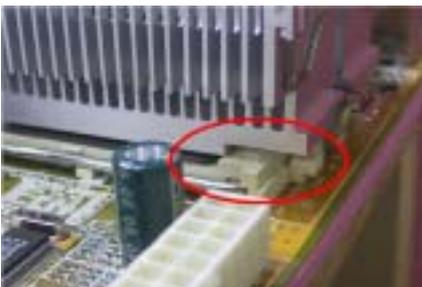
**Wir empfehlen Ihnen sehr, ein Kühlblech mit drei Löchern in der Befestigungsplatte zu verwenden. Dies sorgt für beste Stabilität und verhindert Schäden an den Sockelbefestigungshaken.**
