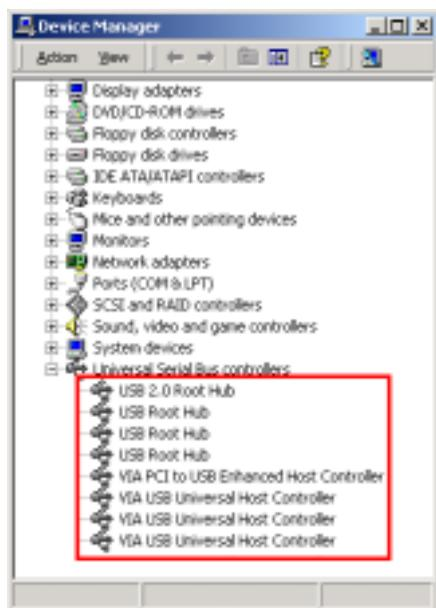
**Schritt 10:** Nach dem Neustart des Systems und Laden des Betriebssystems können Sie im “Gerätemanager” nachprüfen, ob die Geräte korrekt installiert sind.
