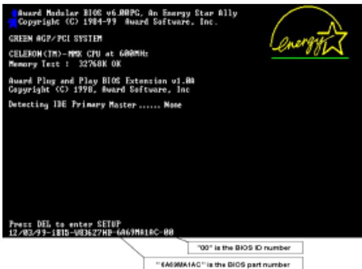
Das aktuelle BIOS-ID in diesem Beispiel ist "00". Wenn Sie bereits über das neueste BIOS verfügen, ist kein Update erforderlich. Verfügen Sie nicht über das neueste BIOS, gehen Sie zum nächsten Schritt.
