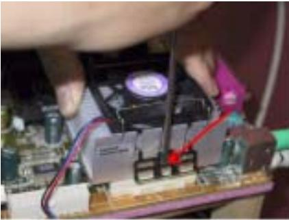
Setzen Sie einen Flachkopfschraubenzieher in den mittleren Schlitz der rechten Befestigungsplatte und drücken nach unten. Nun können Sie die Befestigungsplatte über die Sockelhaken auf der rechten Seite schieben. Siehe Foto links.
