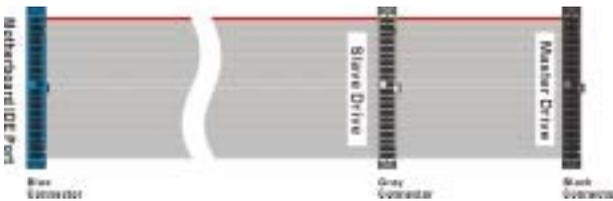
**Abb. 2-8. Ultra DMA 66 Flachkabel - Umriss**
