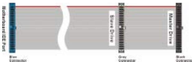
Figure 2-8. Schéma d'une nappe de connexion Ultra DMA 66
