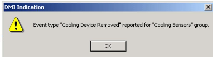
또한 PIC는 제거된 팬이 더 이상 보고되지 않도록 PIC 인터페이스를 새로 고칩니다. 예를 들어, 다섯 개의 팬을 지원하는 시스템에서 팬 3을 제거하면 PIC는 팬 3의 상태는 표시하지 않은 채 팬 1, 팬 2, 팬 4 및 팬 5의 상태를 표시합니다.
