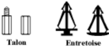
Figure 2-1. Schéma d'un talon et d'une entretoise
