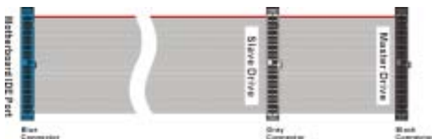
Figure 2-10. Schéma d'une nappe de connexion Ultra DMA 66
