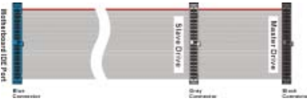
Illustration 2-10. Schéma d'une nappe de connexion Ultra DMA 66
