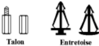
Figure 2-3. Schéma d'un talon et d'une entretoise
