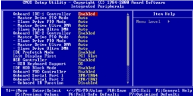
Figure 3-6A. Partie supérieure de l'Integrated Peripherals Menu (KT7/KT7A)
