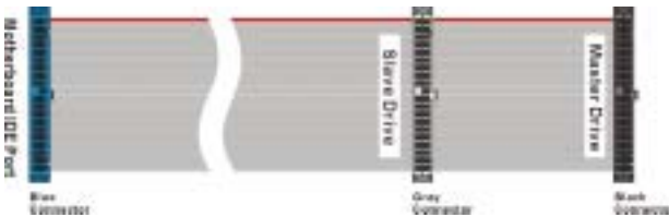
Abb. 2-8. Ultra DMA 66 Flachkabel - Umriss
