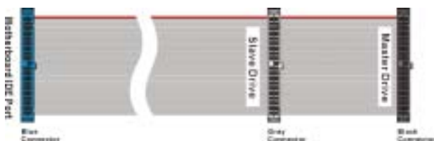
Illustration 2-8. Schéma d'une nappe de connexion Ultra DMA 66
