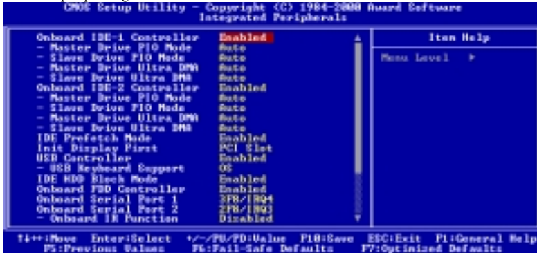
Abb. 3-6A. Integrierte Peripheriegeräte – Voreinstellungsmenü (KT7/KT7A)
