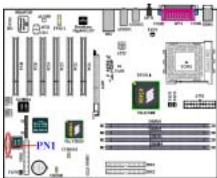
Les PN1 sont pour les interrupteurs et les témoins du panneau frontal de l'ordinateur, plusieurs fonctions proviennent de ce socle de connecteur. Vous devez faire attention à la position des broches et à leur orientation ou vous pouvez provoquer un mauvais fonctionnement des DEL. La figure ci-dessous montre les fonctions PN1 des broches.
