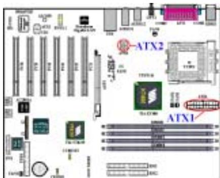
Branchez ici l'alimentation électrique ATX sur les connecteurs ATX1 et ATX2 (les unités d'alimentation électriques ATX conventionnelles ne possèdent pas de connecteur ATX12V1, aussi n'avez-vous pas besoin de brancher quoi que ce soit sur le connecteur ATX2). N'oubliez pas que vous devez pousser fermement sur le connecteur de l'unité d'alimentation pour la brancher sur les connecteurs ATX1 et ATX2, pour être sûr d'avoir une bonne connexion.
