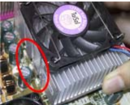
Abb. 4. Installation des Kühlkörpers
