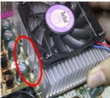
Figura 4. Installazione del dissipatore di calore
