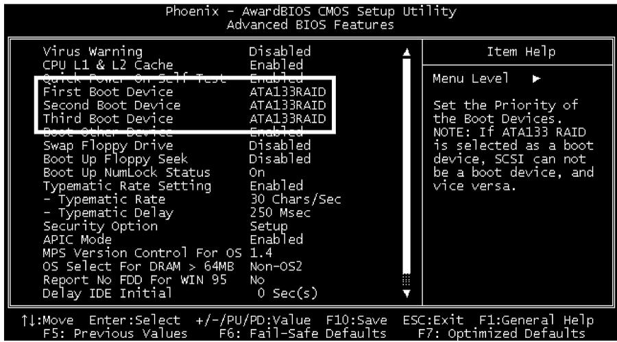
**ANMERKUNG:** Die Option **“SCSI”** kann nicht als Boot-Gerät eingestellt werden, wenn **“ATA133RAID”** als Boot-Gerät ausgewählt wurde, und umgekehrt.
