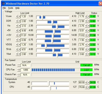
9. Dieser Bildschirm erscheint. Der Hardware Doctor zeigt die Statuswerte für Spannung, Lüftergeschwindigkeit und Temperatur. Sobald ein Wert in einen kritischen Bereich kommt oder sein Soll überschreitet, wird die Anzeige rot und ein Fenster springt auf und meldet Ihnen, dass ein Problem mit dem System vorliegt!
