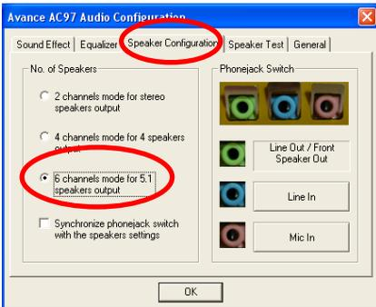
7. Wählen Sie in diesem Lautsprecher-Konfigurationsregister “6-Kanal-Modus für 5.1-Lautsprecherausgabe“, um das 6-Kanal-Audiosystem zu aktivieren.
